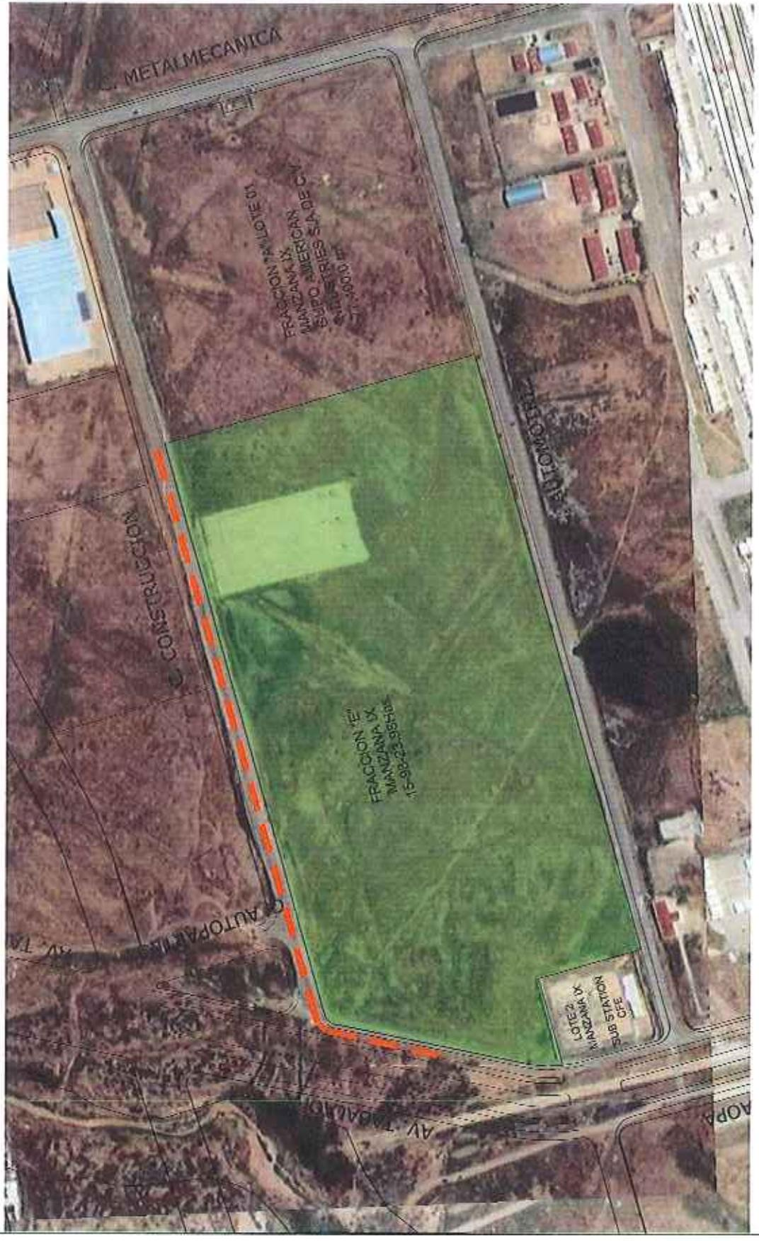
Elaboración de un proyecto eléctrico para extensión de línea en media tensión 22.8 KV en la calle Construcción y Fracción de la Manzana IX, dentro del Parque Industrial Chihuahua Sur, en el Municipio de Chihuahua.
